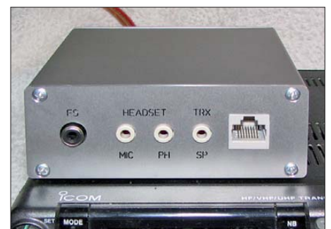
Bild 2: Ansicht der Rückseite des IC-7000-Controllers; die RJ45-Buchse wird mit der Mikrofonbuchse des Transceivers verbunden.
