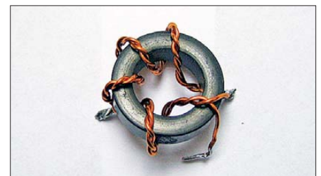
Bild 9: Aufbau T2 für Splitter
