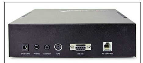
Bild 4: Die Rückseite des Peilers mit den Anschlüssen für Stromversorgung, NF-Ausgang, Empfangs-NF, GPS-Modul, PC und Antennenschalter
