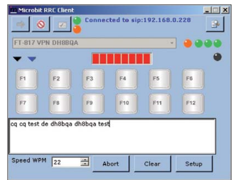
Bild 10: Der im PC-Client des RRC-Micro integrierte CW-Keyer bietet den Zugriff auf zwölf definierbare Textbausteine und die direkte Eingabe von sofort auszusendendem Text. Fotos, Screenshots: DH8BQA (4), Werkfotos (2)
