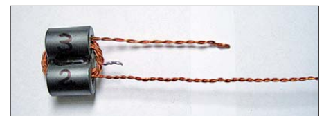
Bild 11: Im zweiten Schritt werden die Windungen aufgebracht.
