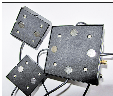
Bild 8: Die Blechkästen der Antennenfüße haften mit starken Magneten.
