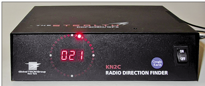
Bild 1: Antenne drehen war gestern, als automatischer Phasenpeiler zeigt der TSCM-2020 die Richtung der empfangenen Funkstation sowohl numerisch in Grad als auch mit einer Windrose an.
