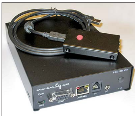
Bild 2: Der PC-Dongle kommt in einem kleinen Metallgehäuse inklusive USB-Kabel daher. Er liegt hier auf dem an der gesteuerten Seite notwendigen RRC-1258MkIIs .
