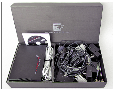
Bild 2: In der erstaunlich kleinen Verpackung finden sich das Grundgerät, fünf Antennenfüße, davon einer mit dem Antennenschalter, ein GPS-Modul, Steckernetzteil, Autoadapter und alle Verbindungskabel sowie eine CD-ROM mit Software und Anleitung.
