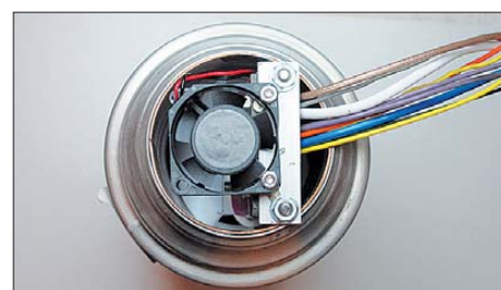
Bild 3: Der 10 mm breite, kreisrund gebogene Kupferstreifen presst sich von innen gegen den Flaschenhals und hält dadurch die in die Thermosflasche eingesetzte Einheit.
