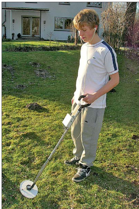
Bild 1: Metallsuchgerät im Einsatz; die gesamte Konstruktion sollte möglichst leicht und gut zu halten sein.
