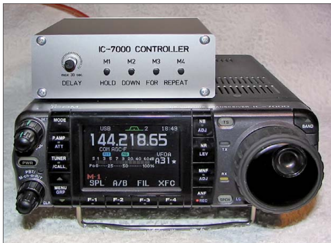
Bild 1: Frontansicht des IC-7000-Controllers; mit dem Potenziometer lässt sich die gewünschte Pausenzeit zwischen 0 s und 30 s einstellen.
