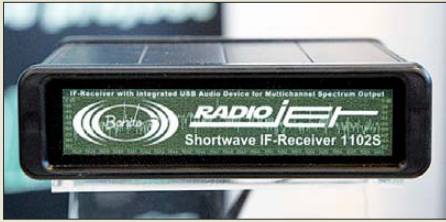
Optimiert für die Lesbarkeit schwacher Signale: Bonitos Radiojet 1102S will SDR mit Direktabtastung ab Herbst Paroli bieten.
