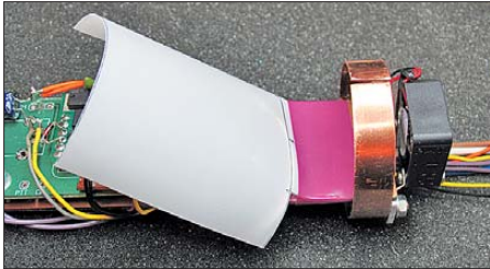
Bild 6: Damit der in die Thermosflasche geblasene Luftstrom den Si570 nicht direkt trifft, ist er mit einer Windschutzhaube aus PTFE-Folie großflächig abgedeckt.
