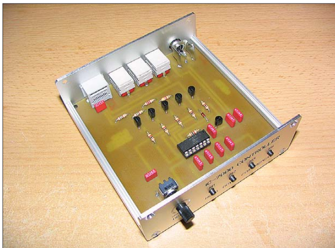
Bild 4: Blick in das geöffnete Gehäuse des Wiederholzusatzes für den IC-7000; die Platine ist großzügig dimensioniert.
