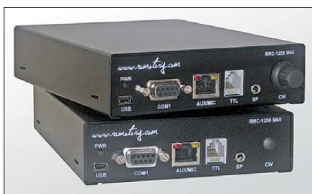
Bild 1: Die aktuellen RRC-Controller tragen die Bezeichnung RRC-1258MkIIs . Die steuernde Seite (oben) besitzt jetzt u. a. standardmäßig ein Potenziometer zur Einstellung der Telegrafiegeschwindigkeit.
