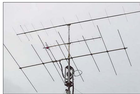
Mitunter reicht eine einzelne Yagi-Antenne, um das große DX zu machen. Es müssen nicht immer 4er- oder größere Gruppen sein, wie die 12-Element-M 2 von Dave, G7RAU, beweist. Foto: G7RAU
