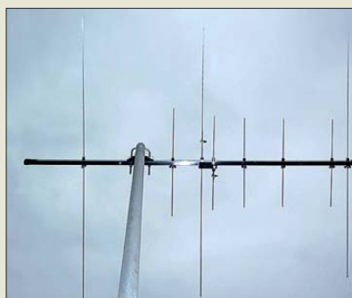
Die Fox-727 ist eine Dualband-Yagi-Antenne für 2 m und 70 cm.
