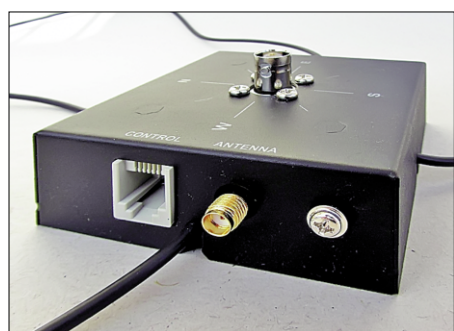
Bild 6: Das zentrale Element der Antennenanlage ist der automatische Antennenschalter, der über zwei Leitungen mit dem Grundgerät und dem Empfänger verbunden wird.
